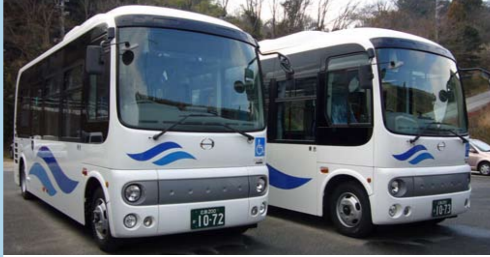
4月から走っている小型バス。床が低く、誰でも乗りやすい設計になっています。
