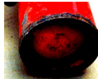
消火器事故の多くは、さびによる腐食が原因です。
