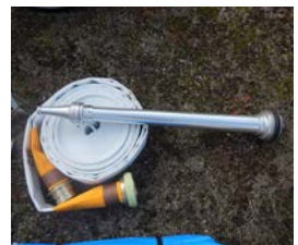
消火栓ホース・筒先
