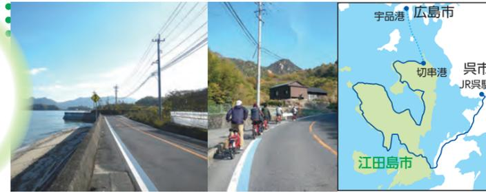
広島県と江田島市は平成25年度から、かしま海道サイクリングロードにブルーラインと距離標の表示整備を進めています。ブルーラインは、路面に引いた青色のラインです。視認性を高め、自動車を運転する方に対して、自転車の走行に注意を促します。自転車の走行は左側（車道）であることを注意喚起するものです。
